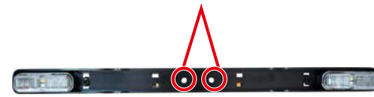
フロントウインカー取付ネジ穴
